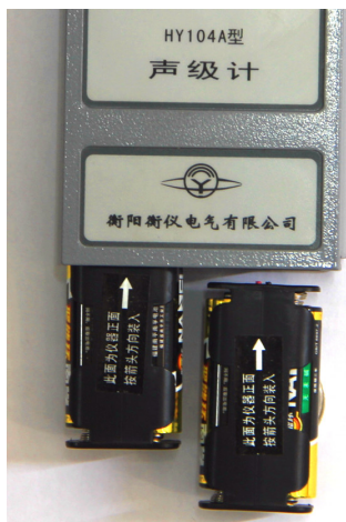
图 8 电池夹的极性
