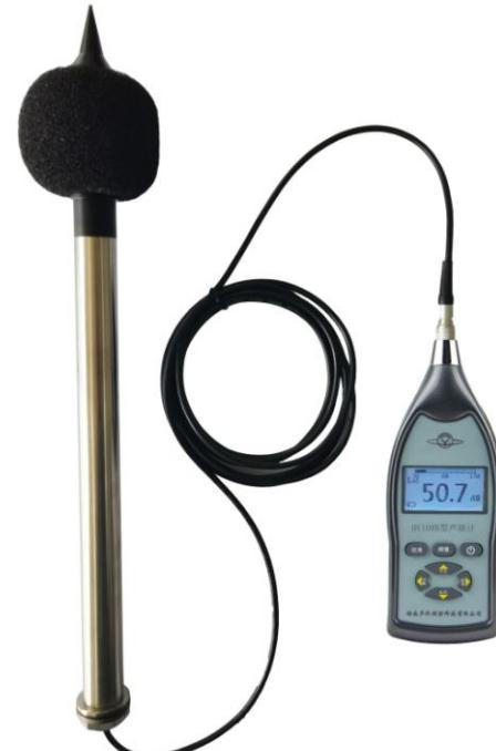
2.13、电源：电源接通自动开机，断电自动关机。可连接USB 端口外接电源适配器(5V 2A)供电（标配），也可订购外接12V电源供电（选配）。
