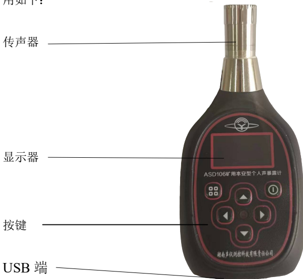
图 1 ASD106 矿用本安型个人声暴露计外形图
